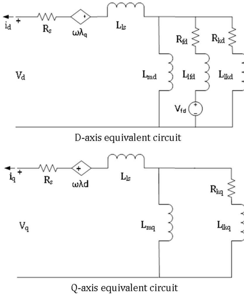
Fig. 4.5: DQ-axis equivalent circuit model of the SG.
