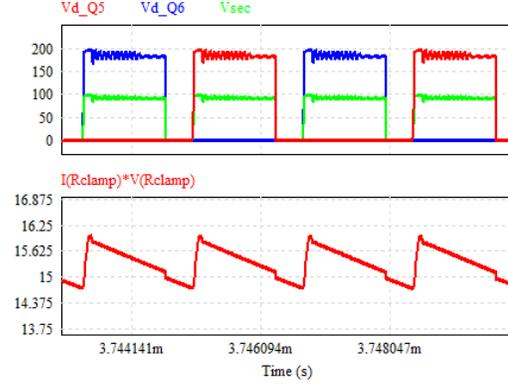
(d) with dual RCD clamping
