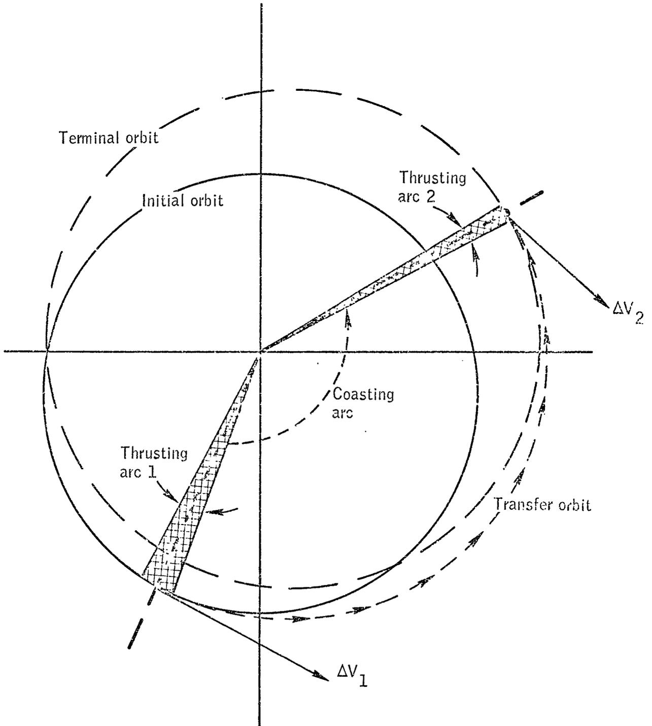
Figure 4.2.- Transfer orbit for Case 1.
