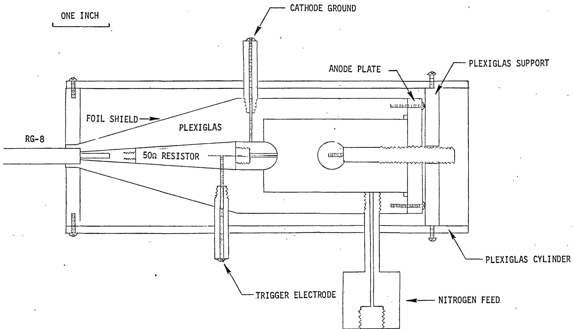
29      FIGURE EIGHT. COAXIAL SPARK GAP PULSE GENERATOR
