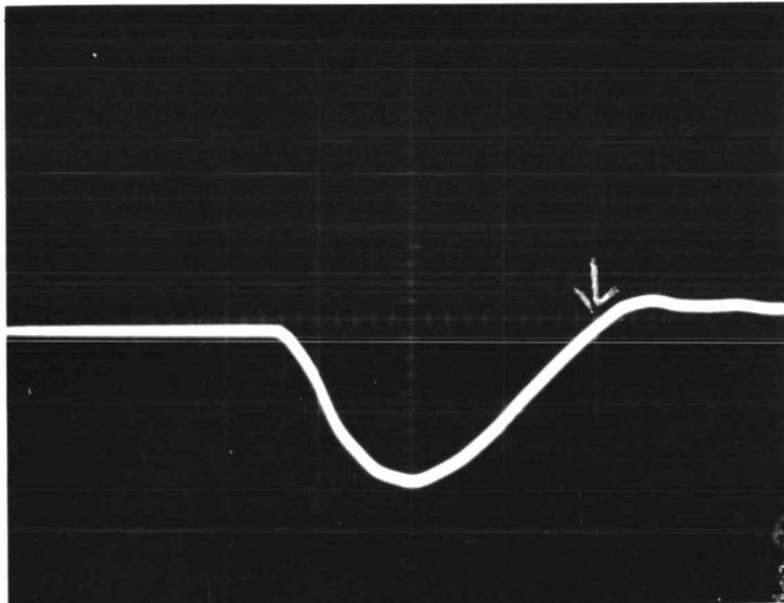
SIGNAL FROM SCR TRIGGER CIRCUIT
