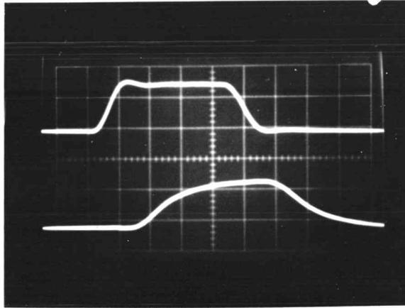
CHANNEL 1 : INPUT WAVEFORM , 10 VOLTS/CM
