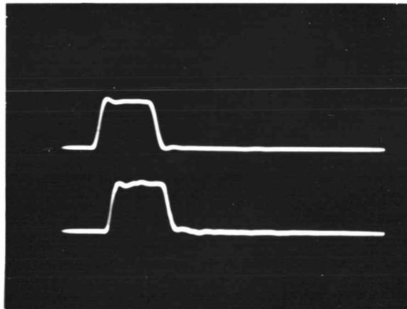
CHANNEL 1 : INPUT WAVEFORM, 10 VOLTS/CM
