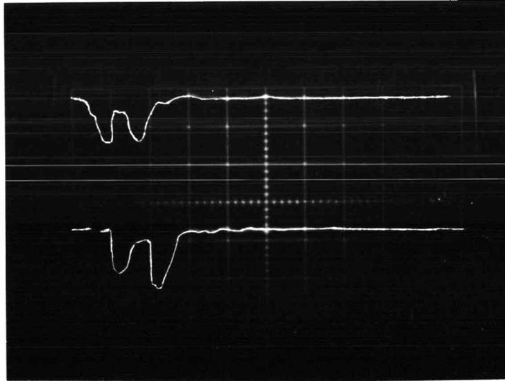
UPPER TRACES : VOLTAGE WAVEFORMS IMPRESSED ON ELECTRON GUN (8 KV)
