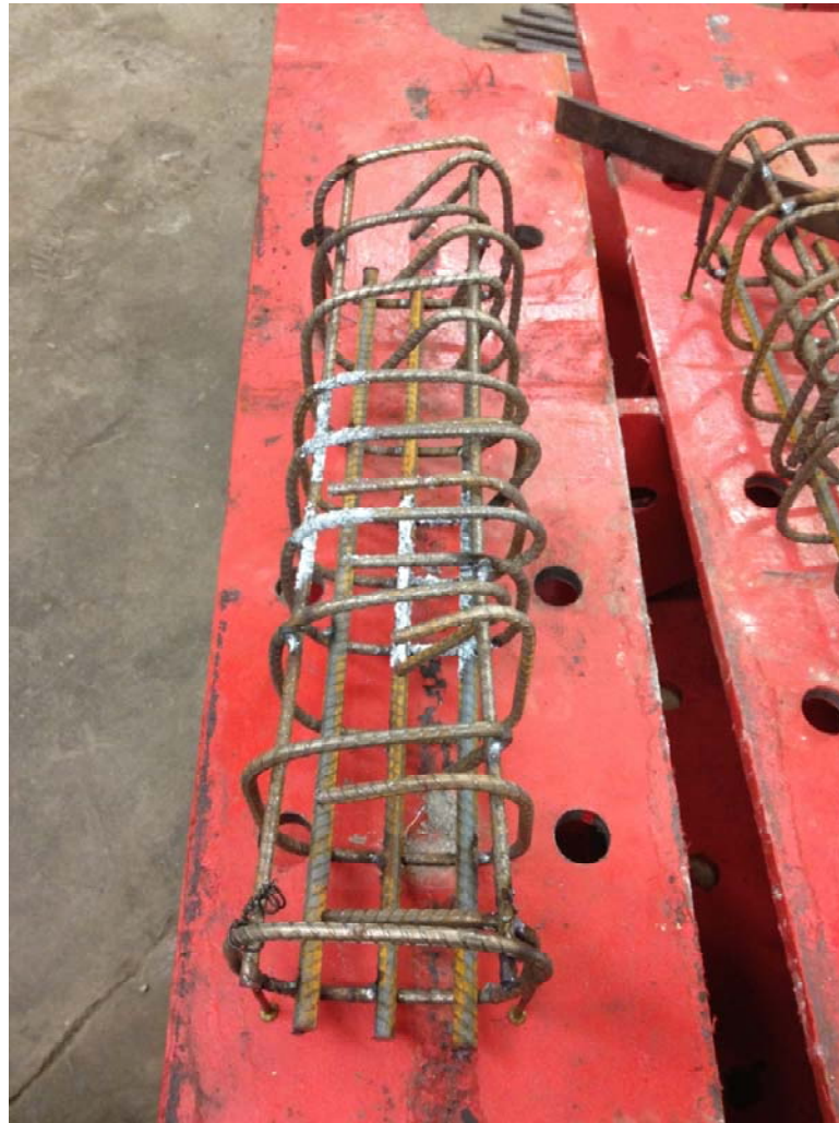
Fig. 7.3 Beam Rebar Cage
